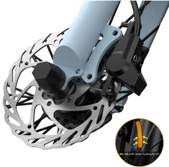
hidroディスクブレーキのワイヤーコアとワイヤーチューブの間には摩擦がなく、ワイヤーチューブの内部は液体の機械伝達のみとなっており、スムーズで迅速な応答性と優れたブレーキ効果が実現します。
